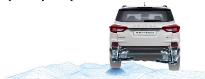
Sjálfstæð fjöðrun á hverju hjóli gerir aksturseiginleika Rexton á ójöfnu undirlagi einstaka.
